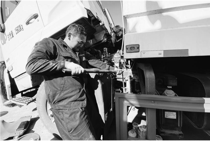
10月30日,西延分公司黄陵管理所邀请专业维修公司为车辆展开全面“体检把脉”,确保除雪机械车辆高效运转。检修过程中,重点对车辆的除雪滚刷、发动机、变速箱、轮胎、燃油、电路等关键部位进行专项检查;全面更换机油、三滤、防冻液及液压油,更换老化零部件,及时排除故障问题,确保在应对冰雪天气时,除雪机械设备能够安全、正常运转。与此同时,维修技术人员详细沟通上一年度除雪机械车辆使用中存在的问题,分析问题产生的原因,并提出了有效解决办法。
